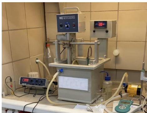
Figura 3: Sistema reacional utilizado na bio-extração de metais de base de sucata eletrônica.
