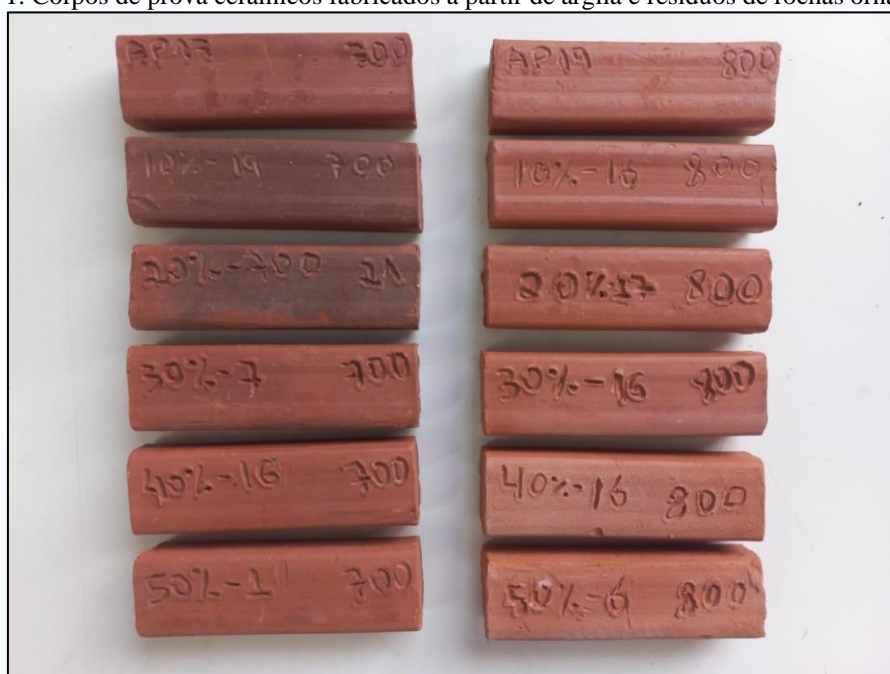
Figura 1. Corpos de prova cerâmicos fabricados a partir de argila e resíduos de rochas ornamentais
